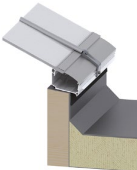
Instalación sobre vigas de madera
