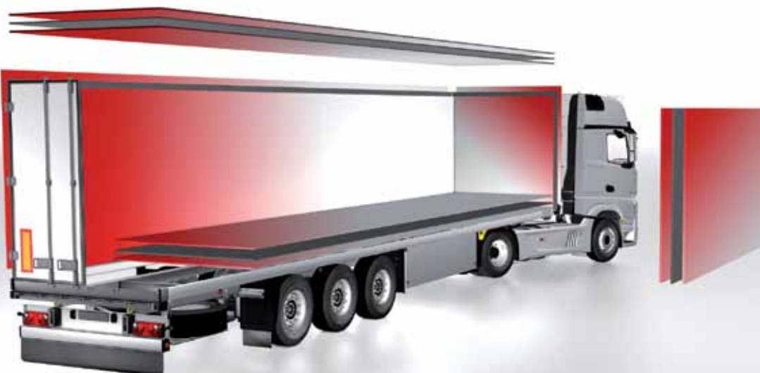
Geringes Gewicht bei höchster Stabilität: Carbon- und glasfaserverstärkte Kunststoffe von LAMILUX finden sich in allen Zonen eines LKW-Aufbaus wieder; im Dach, den Seitenwänden und dem Boden.
