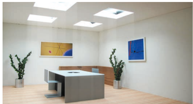
Tapa altamente reflectante TQ máximo en la superficie de trabajo de aprox. un 8 %
